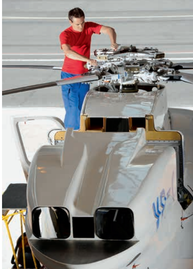
Unterhaltsarbeiten an einem Sikorsky S-76
