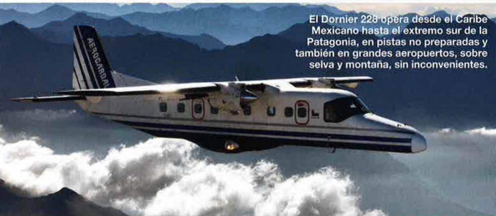
El Dornier 228 tiene una gran capacidad para realizar misiones de patrulla marítima y SAR, gracias a su rango de velocidades, su autonomía, el ala alta sin montantes y su cabina espaciosa.
