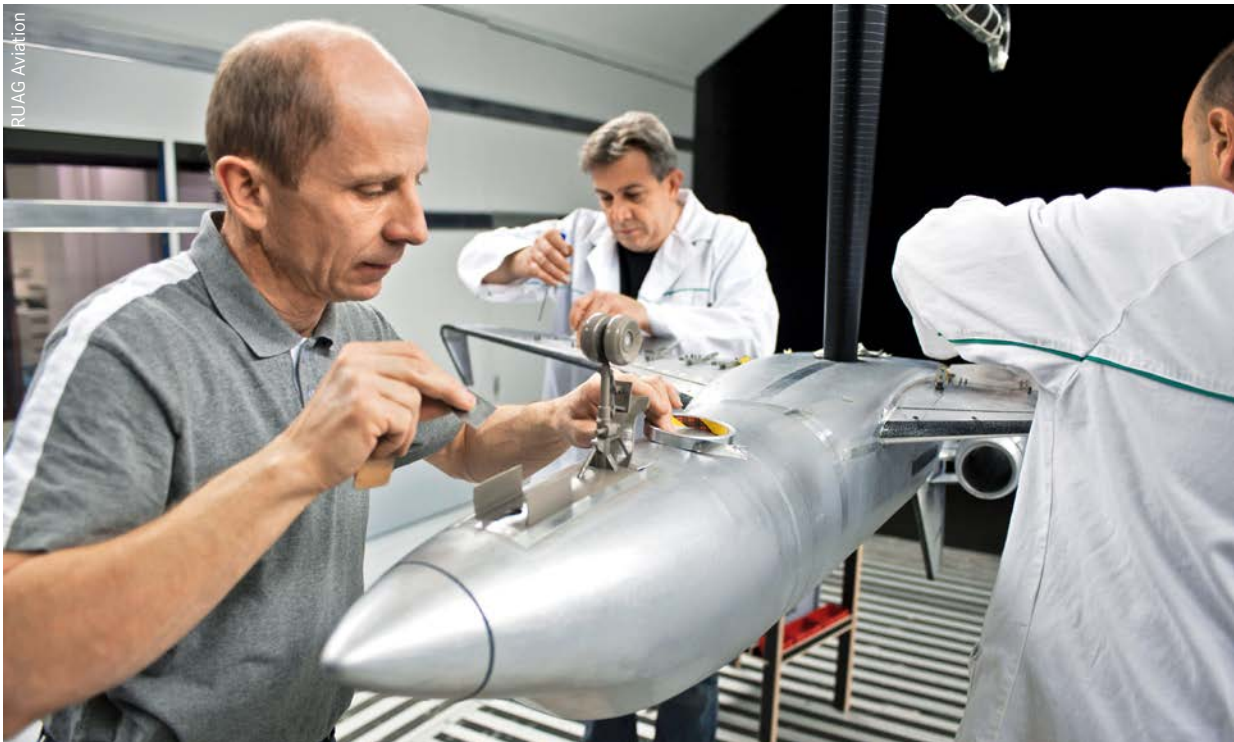
Die Windkanalmodelle sind hochpräzise gefertigt und müssen grossen Luftkräften standhalten. Das Modell wird zur Messung im Windkanal exakt justiert.
