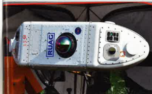
Der ISSYS-POD von RUAG als Schutz von Hubschraubern und kleineren Flugzeugen. (Foto: RUAG )
