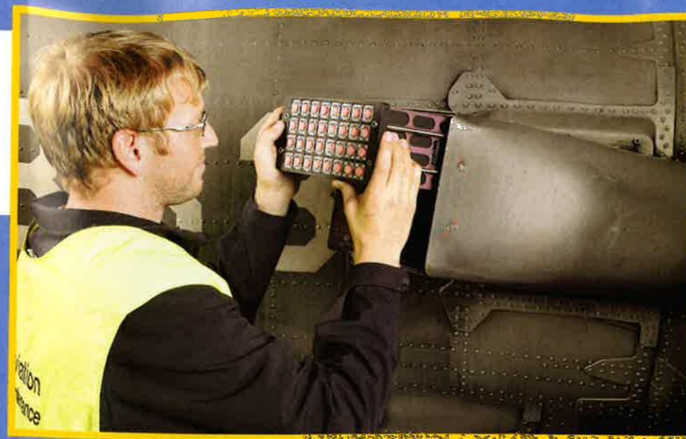
O CAST-easy é instalado no mesmo suporte dos lançadores de chaff/flare.
